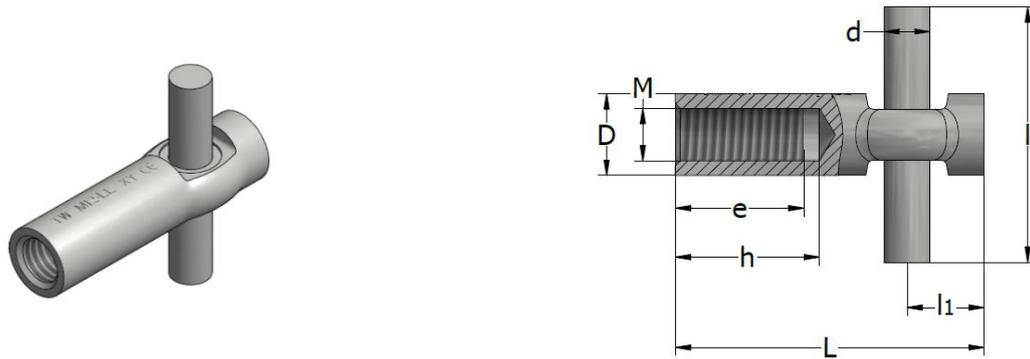
Les inserts de fixation HBUS sont en barre d'acier 11SMnPb30 (W 1.0718) galvanisée (EV) ou en barre d'acier inoxydable A2 – 304 / 1.4305 (SS2) ou A4-316Ti / 1.4571 (SS4). La goupille transversale est en barre d'acier S235JR. **N'utilisez pas ces inserts pour le levage.**
